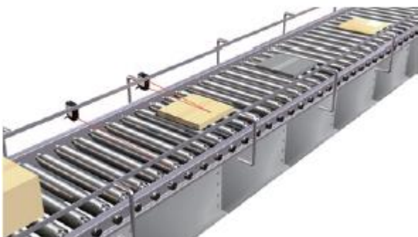
段ボールの通過確認
