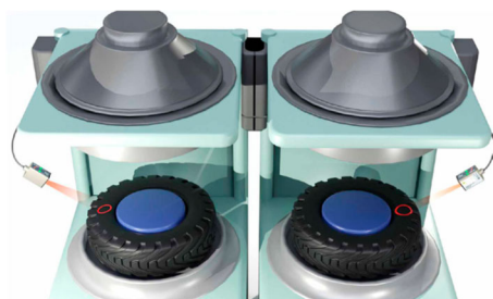
タイヤ加硫工程での加熱時間制御
