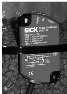
樹脂原料ペレットの レベル検知
