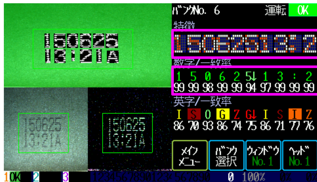
弊社文字認識用画像センサMVS-OCR2の検査画面
