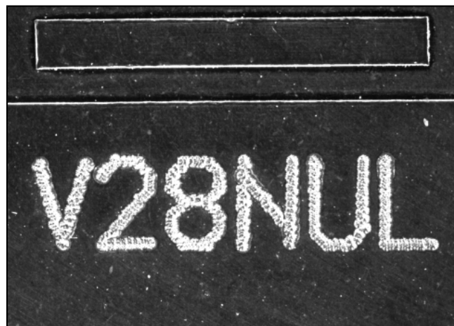
〈ローアングル照明〉 反射／暗視野
