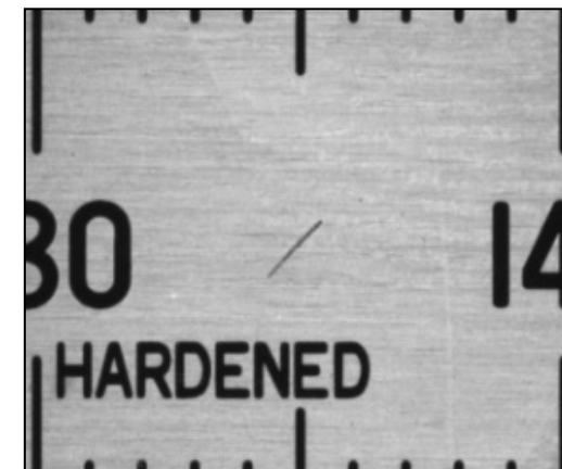
〈同軸照明〉 反射／明視野
