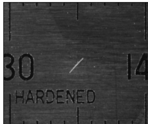
〈ローアングル照明〉 反射／暗視野
