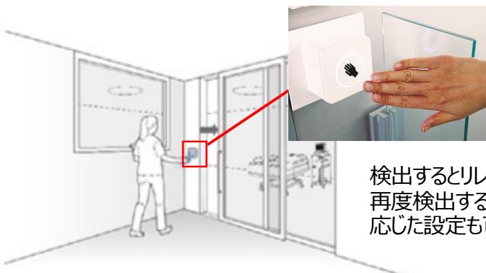
10~50cmの範囲に手を近づけることでドアが開閉します。ドアノブやスイッチに直接触れなくても反応するため、衛生面やウィルス・細菌の感染リスク軽減に有効です。
