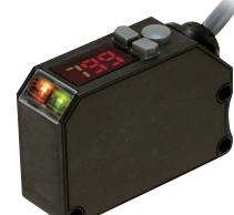
色判別ができるカラー/モード搭載。設定した色だけを判別できます。RGBの3色を常に投光し、その比率を演算するので、ワークのバタツキにも強くなります。検出対象物に応じて、マークモードとカラーモードを1つのセンサで選択できます。
