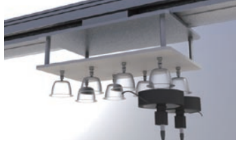
ロボットハンドリング上にて検査
