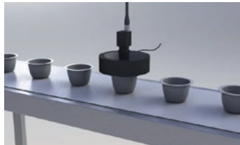
コンベア上にて移動中検査
