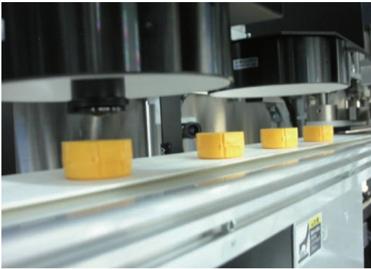
側面・天面検査
