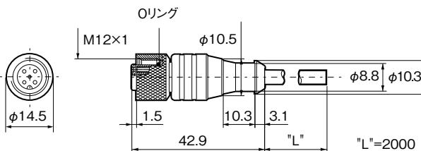
ケーブル部材質:PVC リード線公称断面積:5芯×0.5mm<sup>2</sup>
