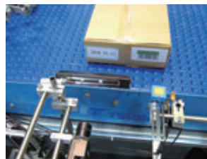
文字認識画像センサ(左)と バーコードリーダ(右)による内容照合検査
