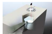
ビューポート越しの浮量測定
